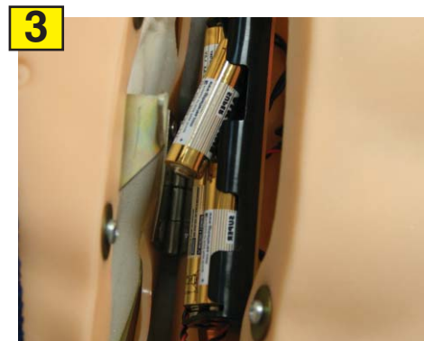
3 Извлечь использованные элементы питания из контейнера и, соблюдая полярность, вставить новые, а затем закрыть тренажер
